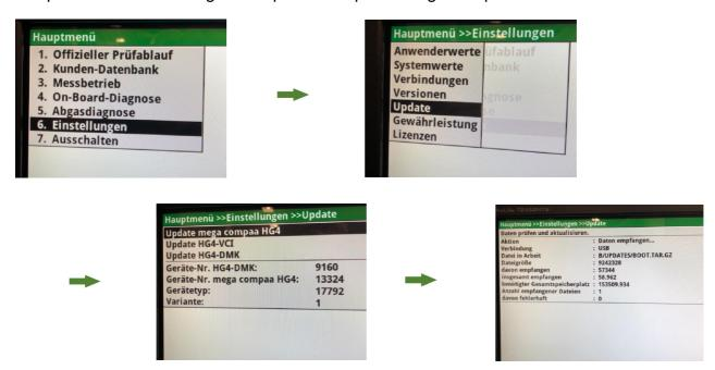
Das Gerät startet nach Beendigung des Updates selbstständig neu. Nach Bestätigen der AGB's aktualisieren Sie außerdem den HG4-VCI. Hierfür den HG4-VCI an ein Fahrzeug anstecken und das Update wie oben beschrieben durchführen. Eine Kabelverbindung ist nicht nötig.
